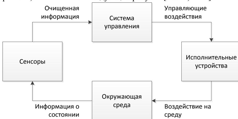
Рис. 7. Общая схема автоматизированной системы управления
